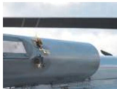
Los impactos de las balas se observan en una hélice y el fuselaje de la aeronave.
