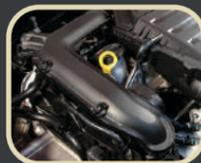
**Motor cuatro cilindros TSI turbo.**
