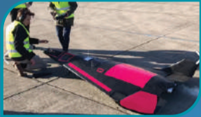
DEMO-1 STELLA Primer demostrador, utilizado para la validación inicial de las características aerodinámicas.
