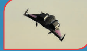
MIRA-Support Vehicle: MIRA-Light Versión reducida del modelo MIRA, su objetivo principal es probar y calibrar los sistemas de control de vuelo de su hermana mayor.
