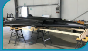
DEMO-4 MIRA Vehículo de validación dedicado a pruebas y demostraciones de vuelo de motores de cohetes lineales aerospike.
